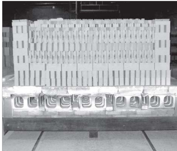
Vypálený žiaruvzdorný materiál vo vozokomorovej peci. Foto: archív Žiaromat a.s.
