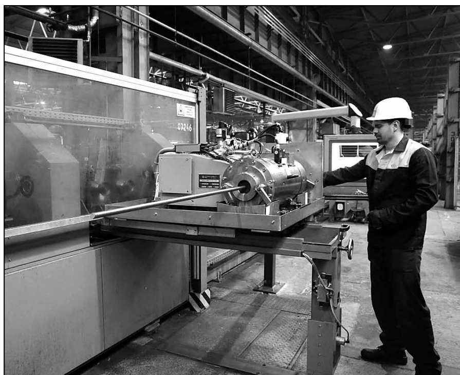
Nové skúšanie rúr ultrazvukom - nastavovanie parametrov objektívom A. Nociarovej
