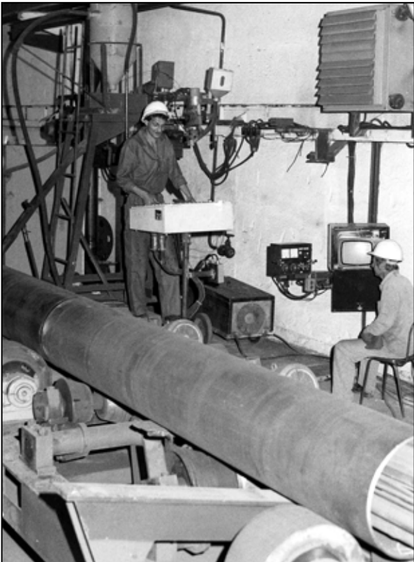
Ján Kiša a Michal Martinec pri zváraní rúr na 12 – metrovej linke. Foto archív.
