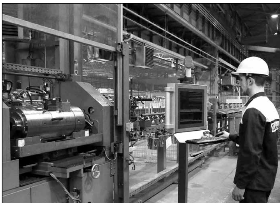
Michal Smieň pri nastavovaní ultrazvukovej hlavy na úpravárenskej linke PRESTAR 2.
