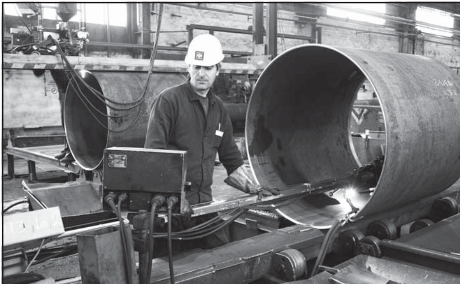
Pracovník zvarovne rúr Ivan Zubal pri zváraní vnútorného pozdĺžneho zvaru na zváracom zariadení WST 1000.
